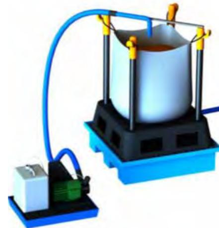
Le module de base est composé d'un portique supportant un filtre et servant au stockage des boues épaissies et d'un **module de pompage** équipé d'une pompe avec un **corps en inox** pour l'aspiration des boues ainsi que d'une **pompe de précipitation** délivrant la juste dose de précipitant pendant l'opération d'épaississement. Pour cette station de 200 EH, il peut être judicieux de disposer de deux ou trois portiques et d'un seul module de pompage.
